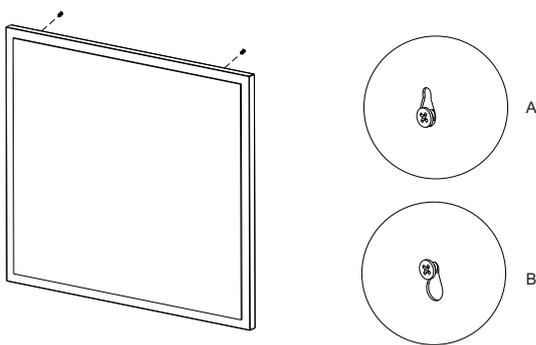
Encaixe a espelheira na parede. Posicione-a alinhando o furo maior da alheta com o parafuso fixo na parede. Obs.: a cabeça do parafuso passará pelo furo maior (A) da alheta e encaixará no furo recortado menor (B).
