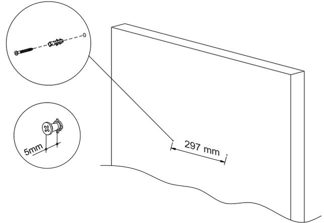
Faça as marcações na parede observando a medida de 297 mm entre os furos, e o alinhamento vertical até o piso. Após confirmadas as medidas, fure a parede com uma broca 6 e coloque as buchas 6 na parede. Fixe os parafusos 4x40 nas buchas deixando 5 mm para fora, para encaixe nas alhetas da espelheira.
