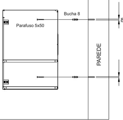
Posicione o toucador na parede de forma que esteja nivelado (utilize um nível) e marque com lápis os furos na parede, passando-o pelos furos do toucador. Afaste o toucador da parede e com uma trena ou metro confirme se as medidas entre as marcações estão conforme os furos do toucador. Fure a parede com broca n.8. Coloque a bucha 8 nos furos, posicione o toucador alinhando os furos com as buchas na parede. Fixe o toucador na parede com parafusos 5x50 conforme o desenho.
