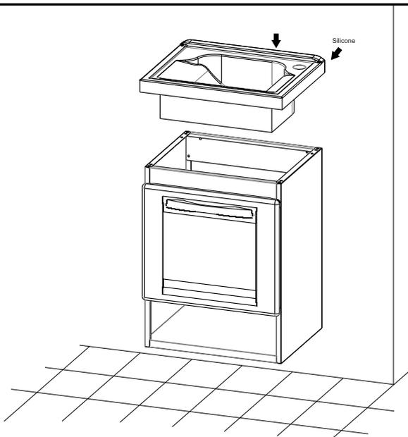
Desembale a pia com cuidado. Instale a torneira e a válvula na pia antes de fixá-la no gabinete. Aplique silicone (não fornecido) nas bordas superiores do gabinete e na parte de trás da pia. Encaixe a pia no gabinete e pressione-a para fixar.
